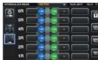
フロントとリアの油圧バルブ、フロントとリアリンクージ、フロントローダーなど、あらゆる油圧機能にコントロールを割り当てることができます。
