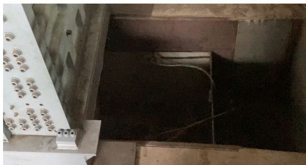
加工後は鉄箱へ落下 (コンタミ対策)
