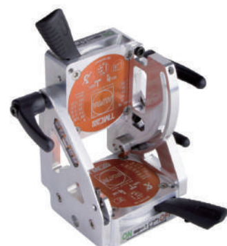
TMA600 (平鋼用) 0-90度固定角度可変
