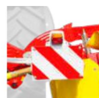
警告表示及び 警告灯
